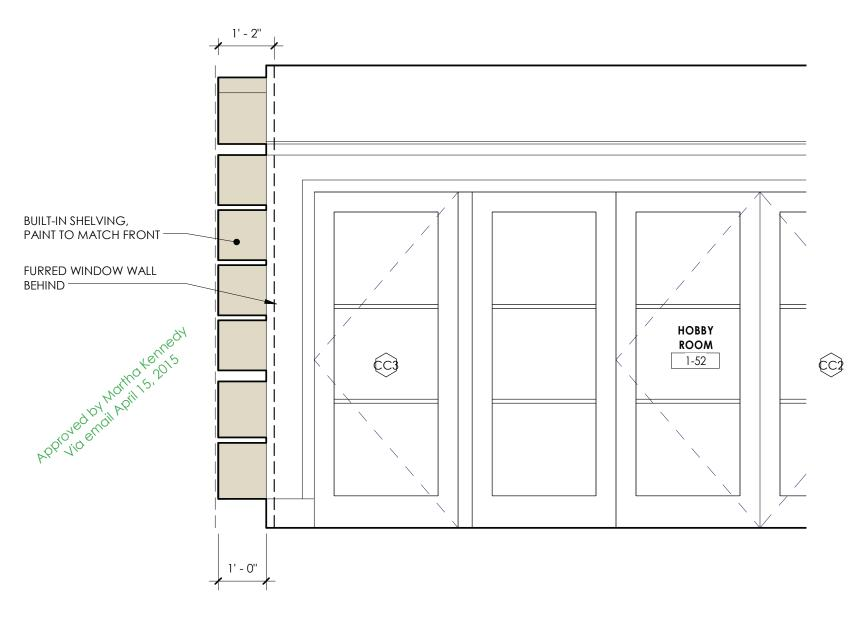
2 CABINETRY PACKAGE - CASITA - HOBBY ROOM - EAST ELEVATION
